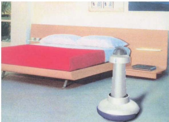
Figura 4. Vista di DMB + Core in un tipiche situazioni di telecontrollo con il supporto telescopico all'unità Core sia esteso, in grado di alzare la telecamera a circa 120 cm da terra, che ritratto.
