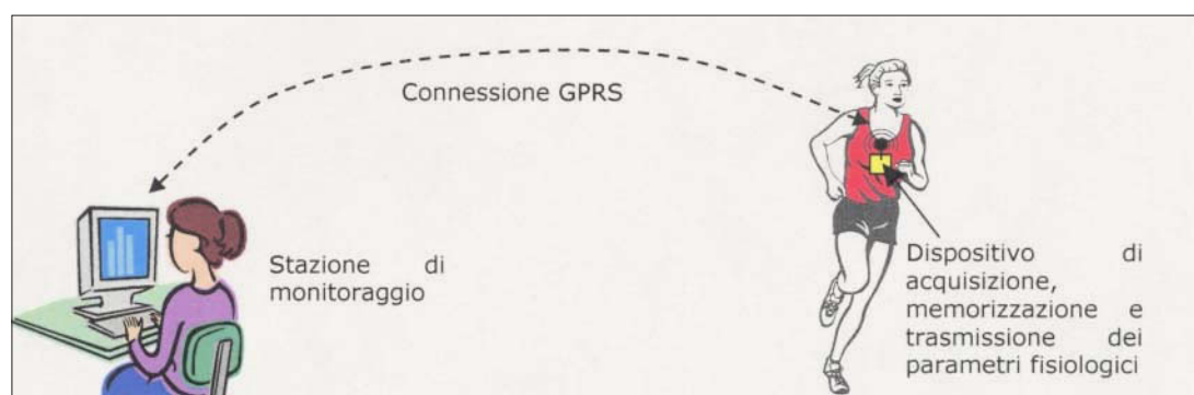
Figura 10. Schema dei rilevamento tramite comunicazione GPRS
